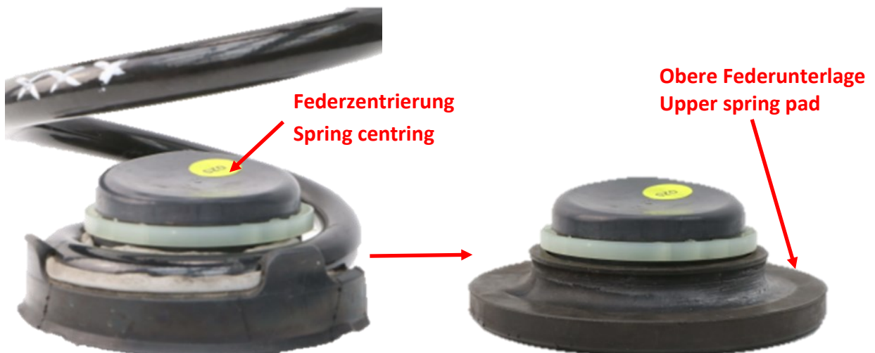
Abb. 3: Untere Federzentrierung mit oberem Federgummi kombiniert Fig. 3: Lower spring centring combined with upper spring rubber
