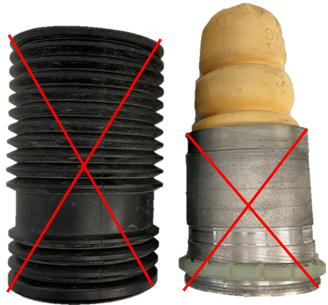
Abb. 2: Pufferauflage mit Schutzrohr Fig. 2: Bump rubber support with dust cover
